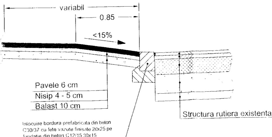
Intocuire bordura prefabricata din beton C30/37 cu fete vazute finisate 20x25 pe fundatie din beton C12/15 30x15 conform STAS 1139-87 tip A1 fig. 1b (pt. forma si dimensiune) si SR EN 1340:2004
