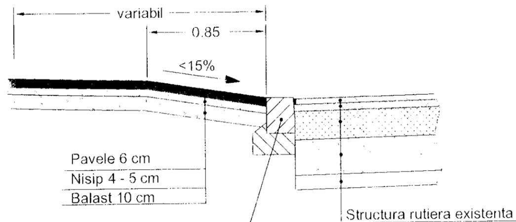
Inlocuire bordura prefabricata din beton C30/37 cu fete vazute finisate 20x25 pe fundatie din beton C12/15 30x15 conform STAS 1139-87 tip A1 fig. 1b (pt. forma si dimensiune) si SR EN 1340:2004
