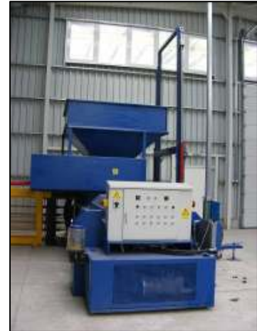
Figură 8. Presă orizontală pentru balotat
